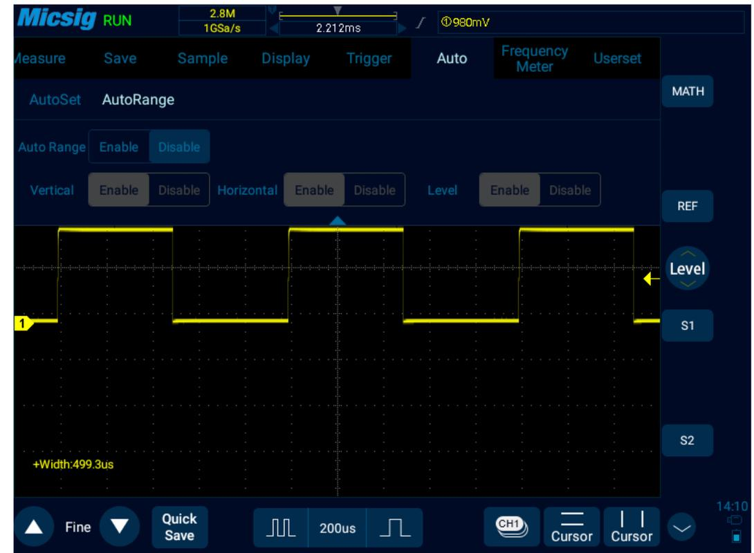
Возможность сохранить осциллограмму в выбранном формате wav, csv, bin
