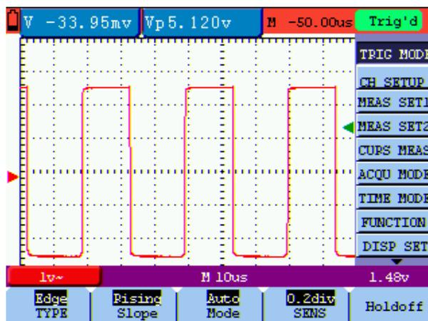
figure 35: Edge Trigger
