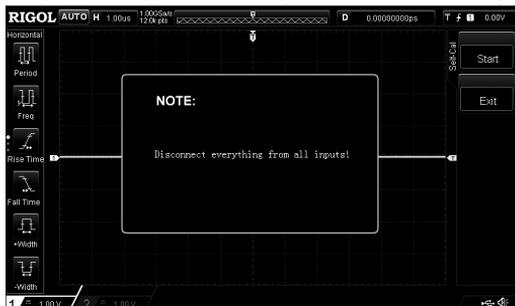
Нажмите **Start** и осциллограф начнет выполнять автоматическую калибровку.
