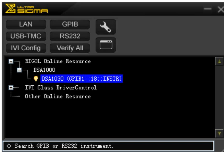
Рисунок 4-9Просмотр подключенного через GPIB измерительного оборудования
