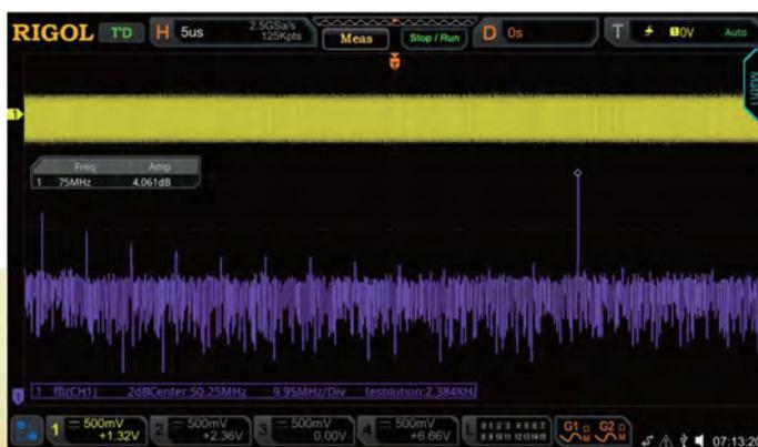
С зондом ближнего поля позволяет легко наблюдать пики на спектрограмме, когда зонд приближается к точке утечки излучения.
