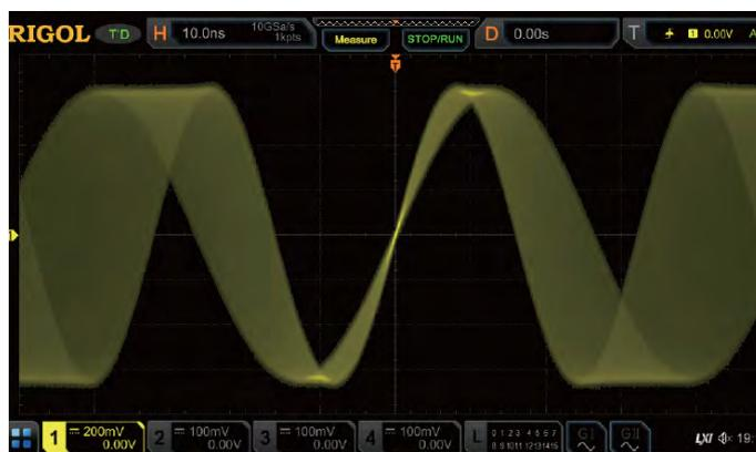
*Изменения каждого кадра осциллограмм сигнала качающейся частоты можно четко наблюдать в режиме высокой скорости обновления*
