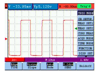
figure 35: Edge Trigger
