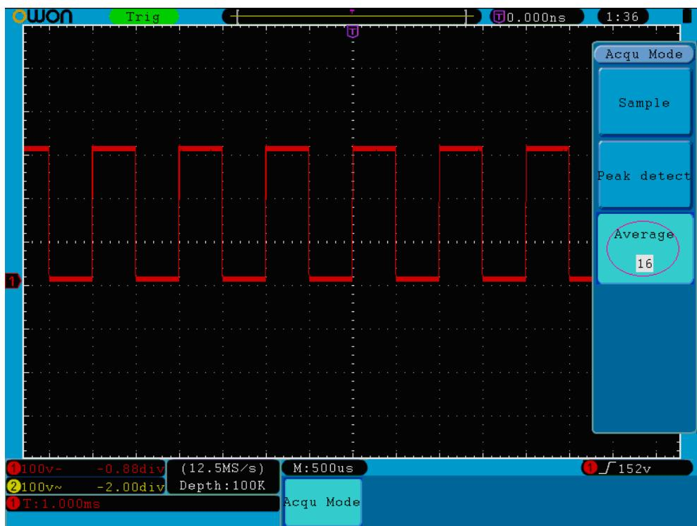
**Рисунок 5-29** Режим усреднения по 16 регистрациям позволил убрать шумы на осцилограмме.
