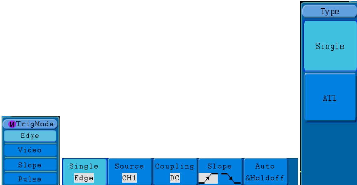
**Рисунок 5-18** Запуск по фронту (**Edge**) для обычного типа запуска (**Single**)
