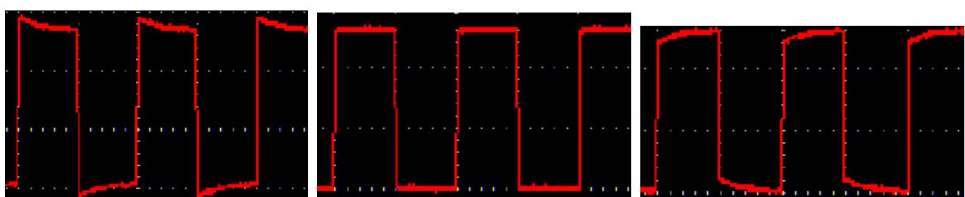
**Рисунок 4-7 Форма сигнала при компенсации пробника**
