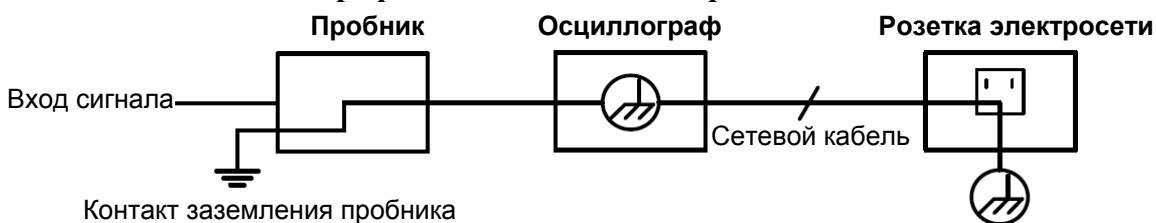
**Схема заземления осциллографа с питанием от батареи при подключении к компьютеру PC, монитору или проектору**
