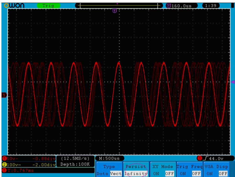
**Рисунок 5-33** Вид осцилограммы с бесконечным послесвечением
