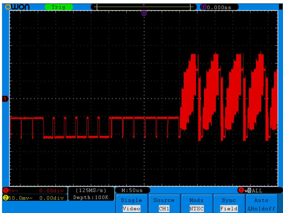
Рисунок 7-7 Осциллограмма сигнала с запуском по кадровому синхроимпульсу
