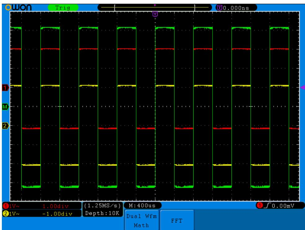
**Рисунок 5-8 Результат использования математической функции CH1 +CH2**
