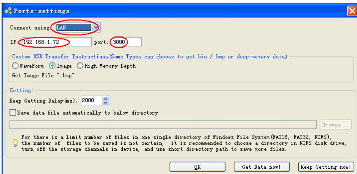
**Рисунок 6-6 Настройка параметров сети в программе OWON Oscilloscope**
