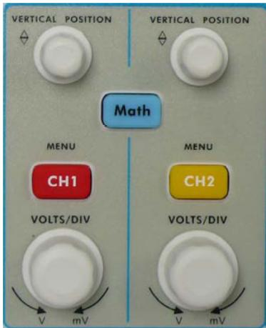
**Рисунок 4-11** Органы управления вертикальной системы
