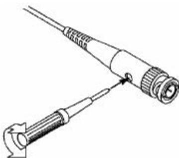
**Рисунок 4-8** Компенсация пробника
