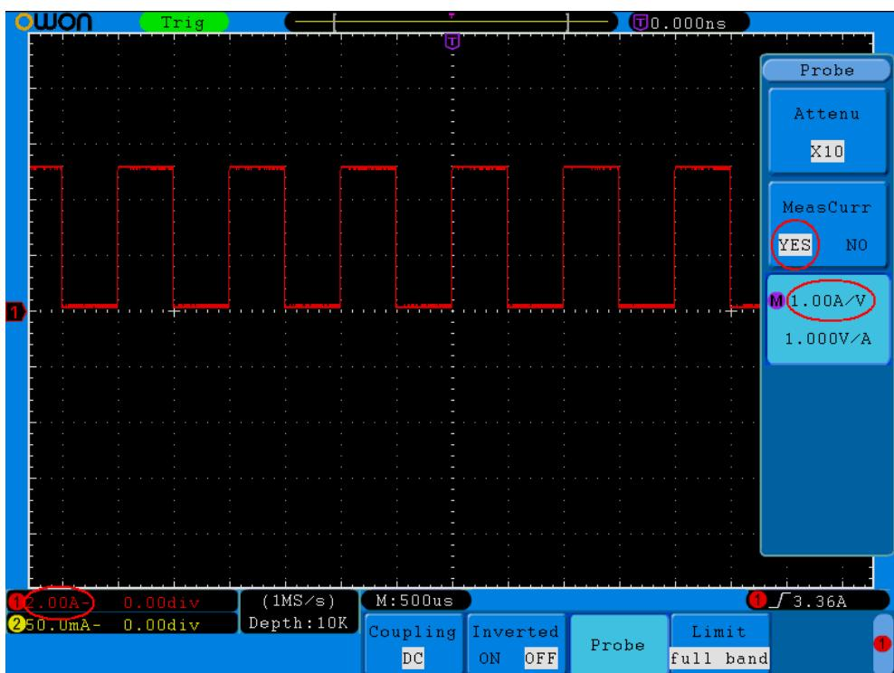
**Рисунок 5-4** Настройки для измерения тока по падению напряжения на резисторе 1 Ом
