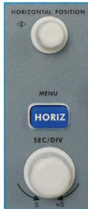
**Рисунок 4-12** Органы управления горизонтальной системы
