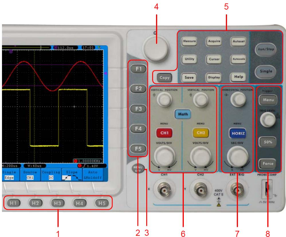
**Рисунок 4-4** Внешний вид кнопок и регуляторов передней панели
