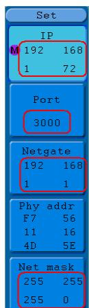
**Рисунок 6-7** Настройка параметров сети в осциллографе
