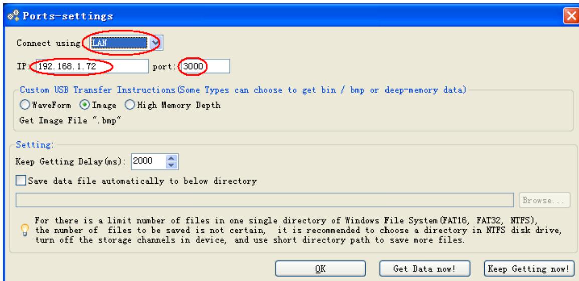
**Рисунок 6-3** Настройка параметров сети в программе OWON Oscilloscope
