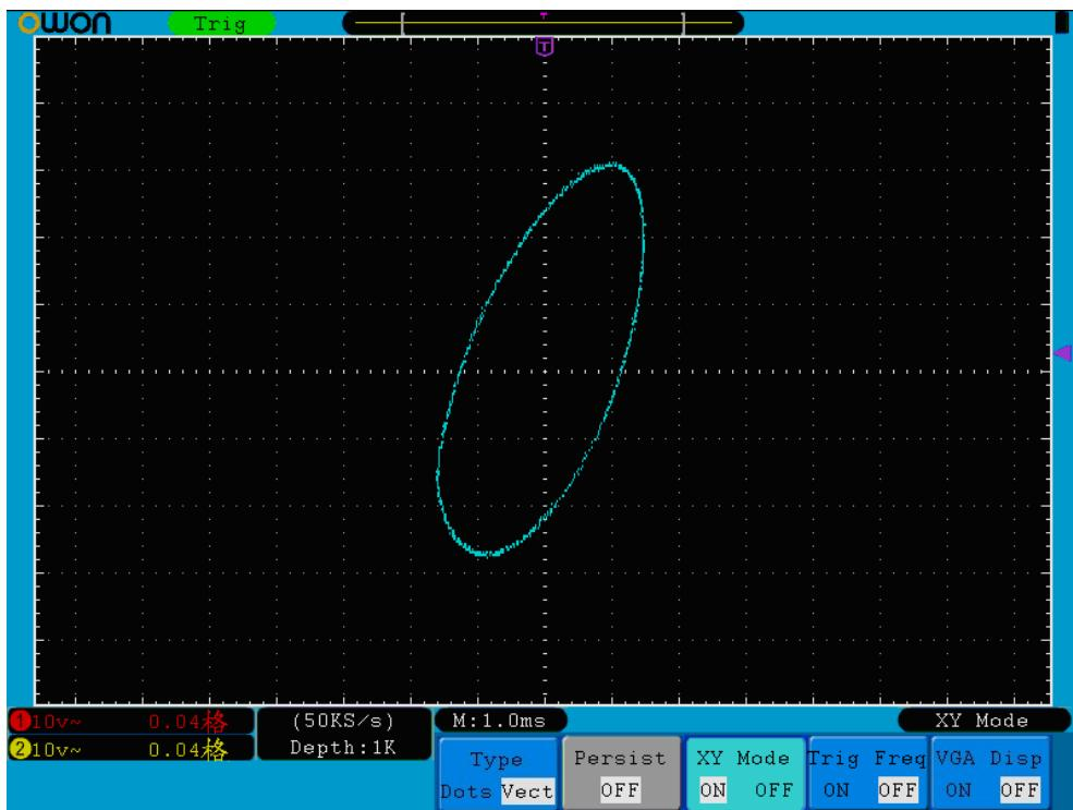
**Рисунок 5-34** Вид экрана при использовании режима XY
