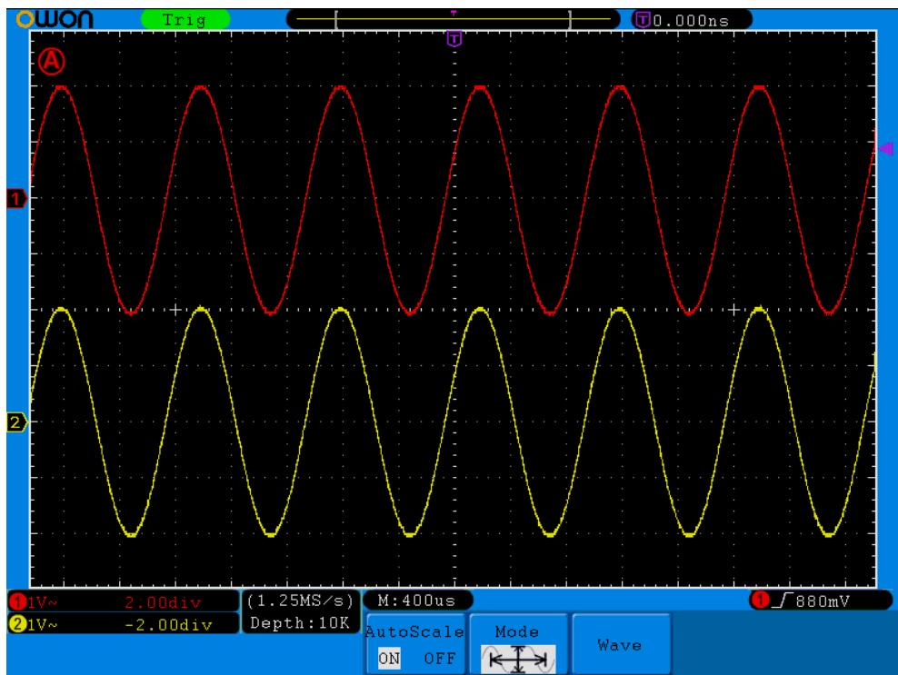
**Рисунок 5-68** Использование автомасштабирования для отображения нескольких периодов
