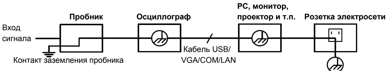
Не допускается производить данным прибором измерение в сети переменного тока при питании осциллографа от электросети, а также, если он подключен к компьютеру или другой периферии, питающейся от электросети.
