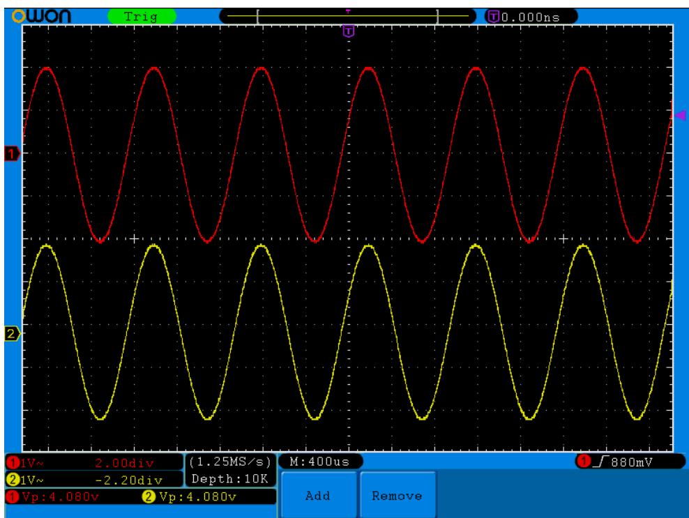
Рисунок 7-2 Осцилограмма определения коэффициента усиления
